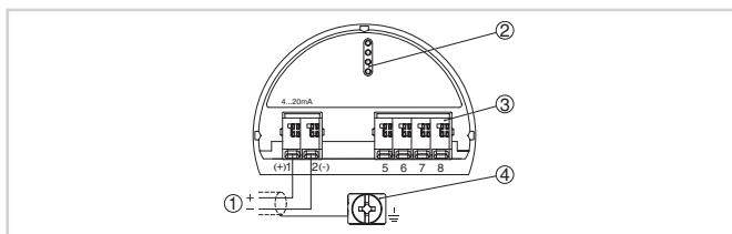
Отсек электроники и подключения (однокамерный корпус)
